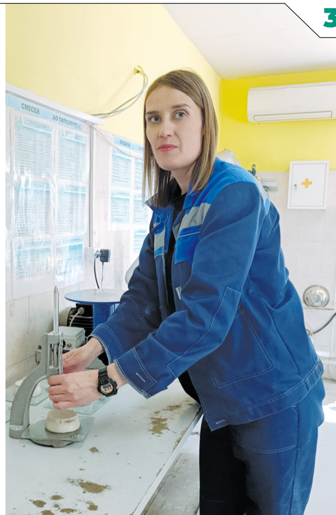
Наталья проводит лабораторные испытания разрабатываемых составов на определение сроков схватывания и подвижности сухих строительных смесей
