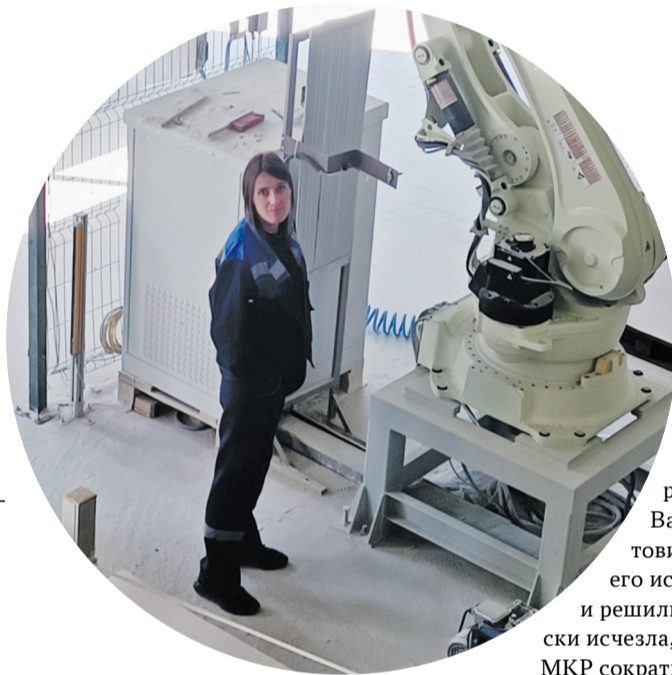
Цех производства сухих строительных смесей, рядом с Натальей – автоматизированный робот-укладчик
