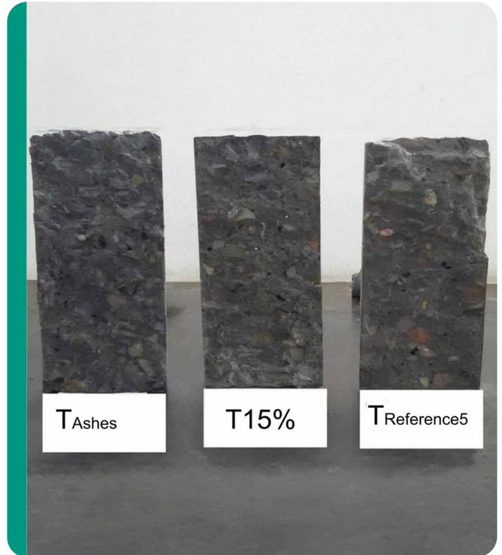
В новом эксперименте индийские инженеры подбирали различные пропорции каучуковых зерен разного размера в мелком заполнителе. Были подготовлены четыре образца смеси, где 5%, 10% и 15% песка заменили на гранулы покрышек, а также «эталонный» раствор, в котором песок остался без примесей. Затем исследователи оценивали полученную смесь по весу и содержанию воздуха, а после затвердевший высокопрочный бетон испытывали на прочность, растяжение, упругость и виброгашение.
