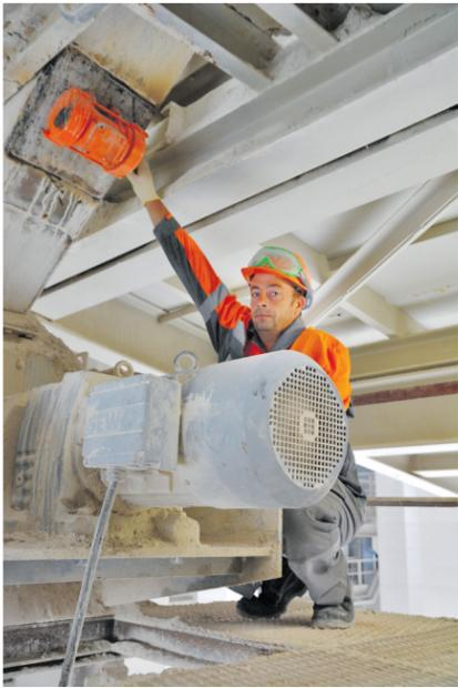
Раціоналізатор Володимир Киселев перевіряє роботу вібратора
