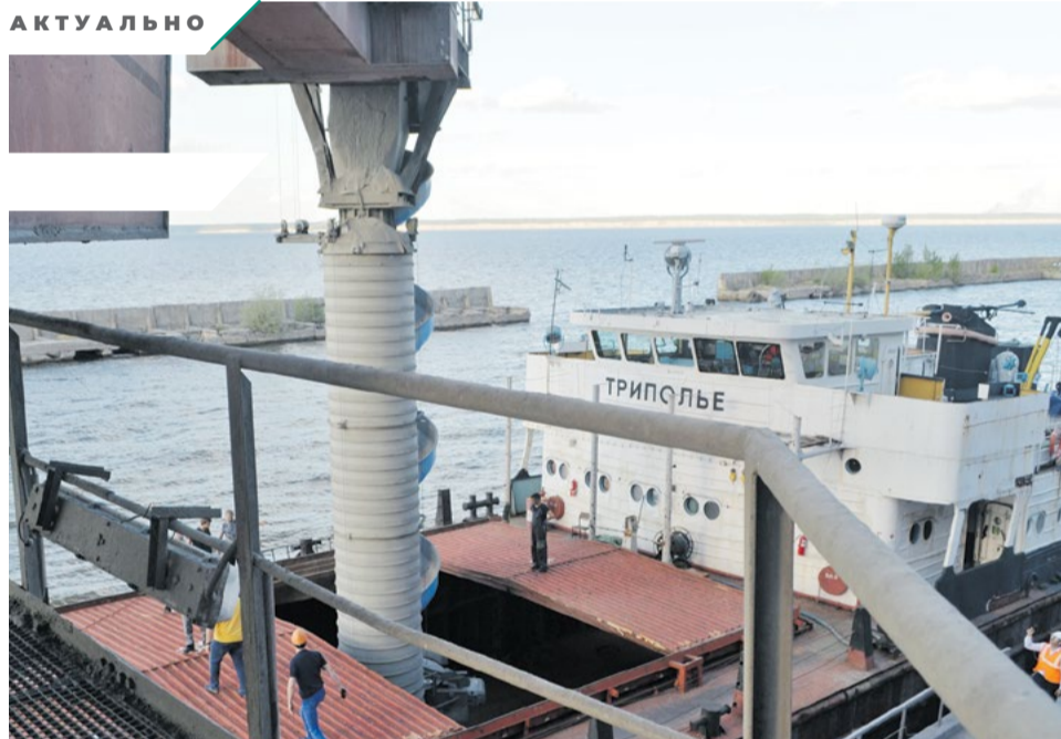
Процесс погрузки навалочного цемента в баржу
