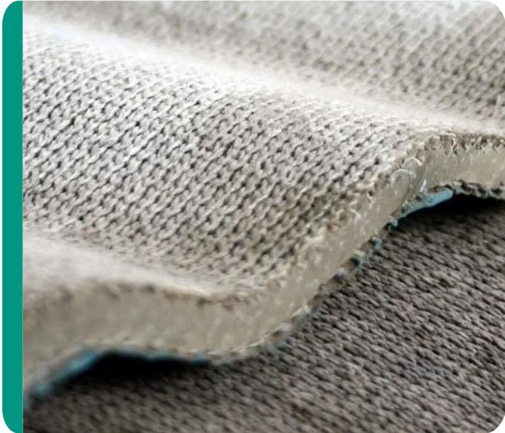
Бетонное полотно (Concrete Canvas) – гибкое, армированное 3D сеткой из полиэфирных нитей полотно, наполненное сухой бетонной смесью, которое после взаимодействия с водой превращается в прочный материал. После смачивания водой бетонное полотно затвердевает, и уже через 24 часа покрытие набирает более 80% прочности и готово к эксплуатации.
