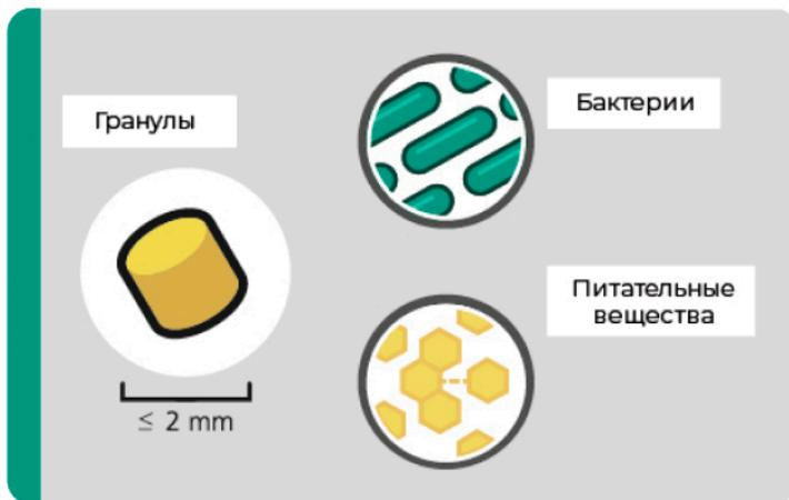
Данная технология предполагает ввод в бетон раствора со специальным агентом, содержащим уникальные бактерии, способные при внедрении в бетон превращать переработанные питательные вещества в известняк – и так в прямом смысле «заживлять» трещины.
