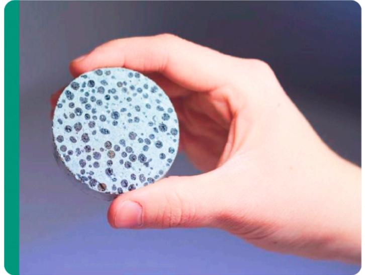
Они практически полностью гидратируют в течение полугода и в дальнейшем не имеют ресурса для продолжения процесса самозалечивания. Поэтому современные ученые ищут пути для создания в теле цементного камня условий для эффективного самозалечивания трещин. Далее опишем несколько технологий.
