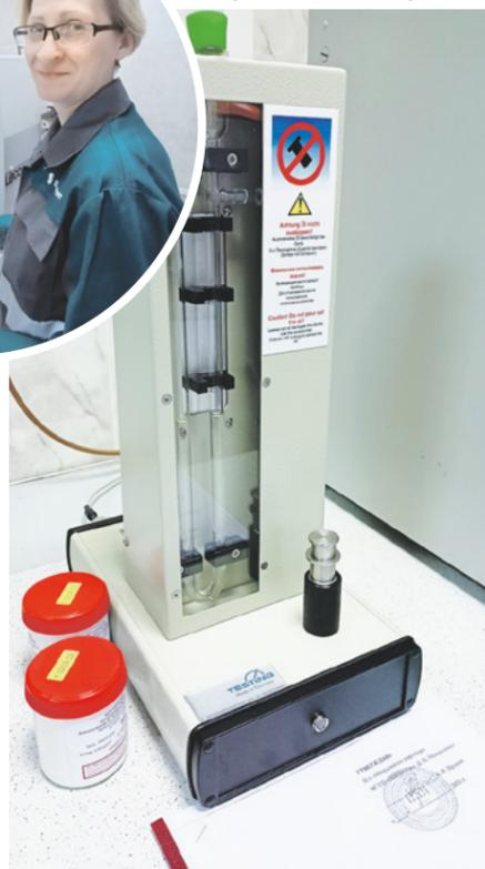
Прибор Блейна фирмы Testing работает автоматически и не требует калибровки
