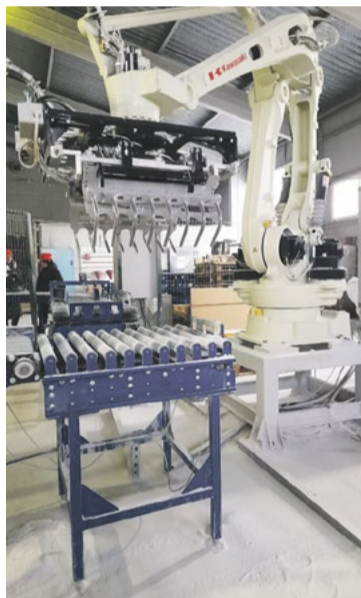
Участок упаковки сухих строительных смесей
