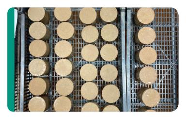
Технология укрепления грунта повышает механические показатели свойств слоев дорожной одежды (пределы прочности на сжатие и растяжение, морозостойкость, набухание и другие), уменьшает срок выполнения строительных работ, а также снижает финансовую нагрузку на организацию, реализующую проект. На схеме ниже визуально представлена технология использования комплексного минерального вяжущего.
