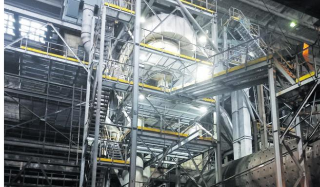
Мельницы на замкнутом цикле обладают уникальными возможностями. За счет того, что мельничный сепаратор разделяет материал на мелкую фракцию для готового продукта и грубую фракцию, которая отправляется на дополнительный помол, цемент приобретает оптимальный гранулометрический состав. Именно этот принцип «двойной очистки» обеспечи-
